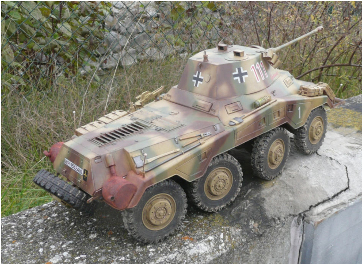
Foto E Auch die komplexe Allradlenkung ist im Modell umgesetzt – in der Serienversion aber auf maximal 15 Grad begrenzt
