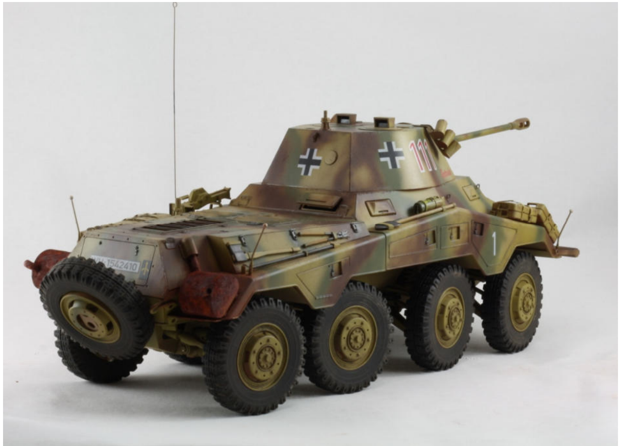
Foto B Auch für Panzerspähwagen galt das Tarnschema mit dem dunkelgelben Grundanstrich mit Tarnflecken aus Olivgrün und Rotbraun.
